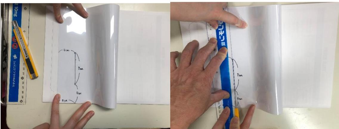
② A4サイズのフィルムの端から4cmのところマジックで印をつけそこから垂直に4cm上方に印をつける。さらに7cm上方まで実線を引いた後、両端をあわせ実線部分をカッターで切る。
